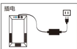
5.插上电源适配器，插头连接到DC12V电源输入。
