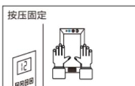
4.撕掉胶带离型纸，水平对准墙壁，按压牢固。
