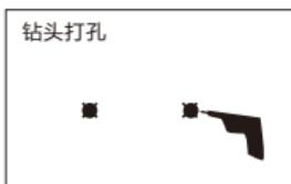
2.用钻头在标记的位置打孔，两个孔的距离为160mm。
