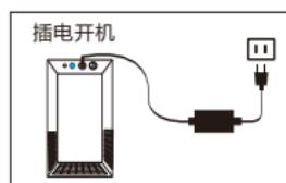
6.插上电源适配器，插头连接到DC12V电源输入。
