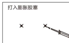
3.在打孔位置打入膨胀胶塞方便固定螺丝。
