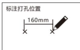
1.安装前确认在墙上打孔的距离，并标记打孔的位置（横竖都可以）。
