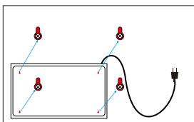
5. 将产品背面的卡位对准螺丝突出位置卡上安装。
