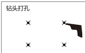
2. 用钻头在标记的位置打孔，孔径6mm。
