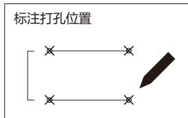
1. 安装前确认在墙上打孔的距离，并标记打孔的位置。
