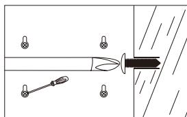
4. 在胶塞上打上螺丝，螺丝不要打尽，留下5mm的突出部位在外面。
